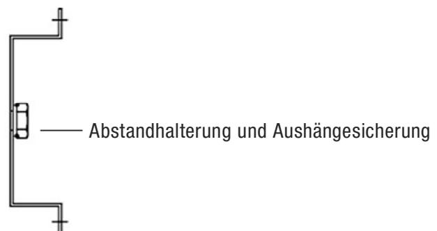
Bei kleineren Anlagen empfehlen wir nach dem Anbringen der Montageschiene und dem Aufhängen der Anlage eine Markierung durch die Abstandhalterung am Mauerwerk vorzunehmen. Hier sollte nach wieder Aushängen der Anlage eine zusätzliche Bohrung an Mauerwerk vorgenommen werden, um die Anlage vor dem Aushängen
